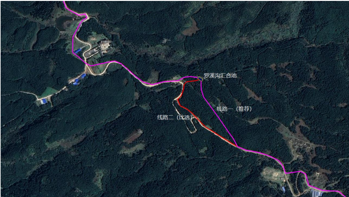
图 2-1 罗溪沟段原水输水管线路比选图
