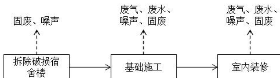
图 3.1-1 电站水毁恢复阶段工艺流程及产污环节
