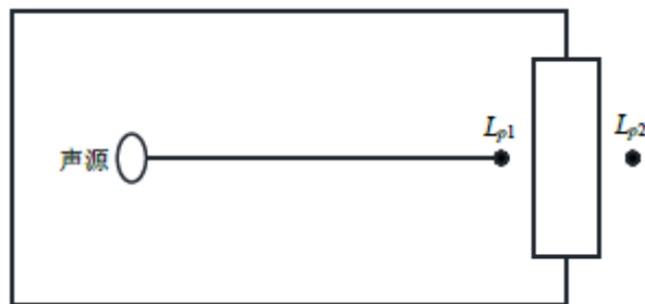
图 4-3 室内声源等效为室外声源图例
