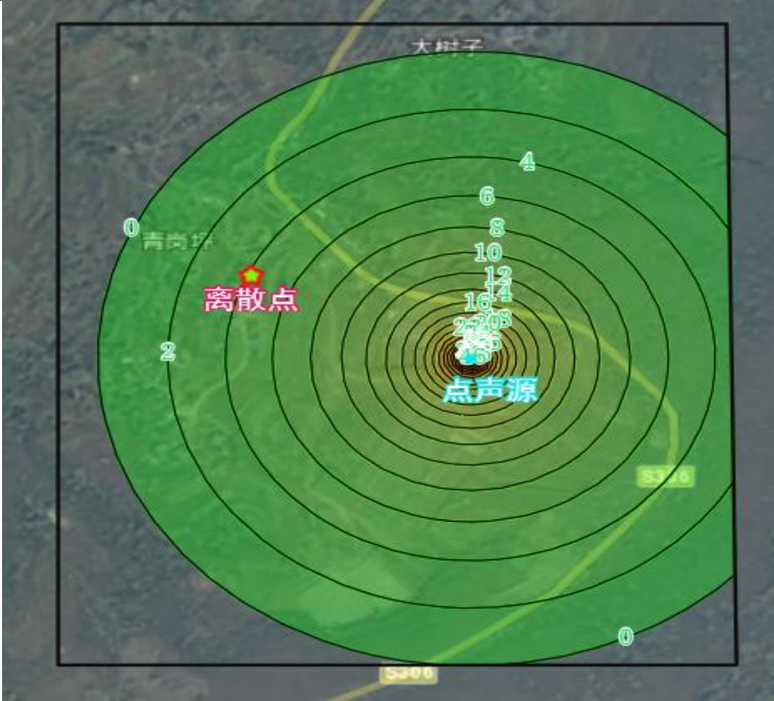
图 7-6 沙坪镇中转站噪声预测等声级线图
